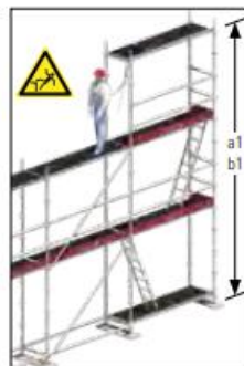
Bild 12: Infästning över huvudhöjd
