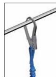
Bild 9: Fästpunkt 4 (OBS! EJ tillåtet på alu-SpeedyScaf).
