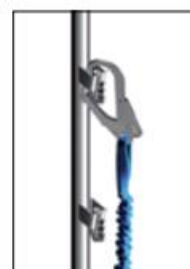
Bild 11: Fästpunkt 5 (OBS! EJ tillåtet på alu-SpeedyScaf).
