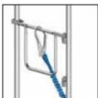
Bild 14: Fästpunkt 6.2 (OBS! EJ tillåtet på alu-SpeedyScaf).
