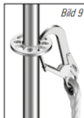
Bild 9: Infästning i kransens stora och små hål möjlig ( enbart för stål-Allround - ej för alu-Allround )
