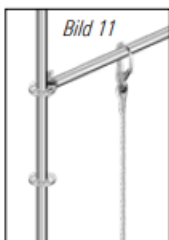
Bild 11: Infästning mot O-horisentalstag (eller U-tvårbom om möjligt)
