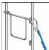
Bild 15: Fästpunkt 6.3 (OBS! EJ tillåtet på alu-SpeedyScaf).
