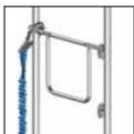
Bild 13: Fästpunkt 6.1 (OBS! EJ tillåtet på alu-SpeedyScaf).
